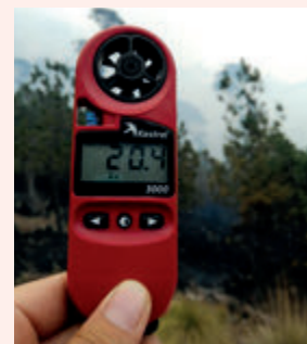
El anemómetro 8 sirve para medir la fuerza del viento.
