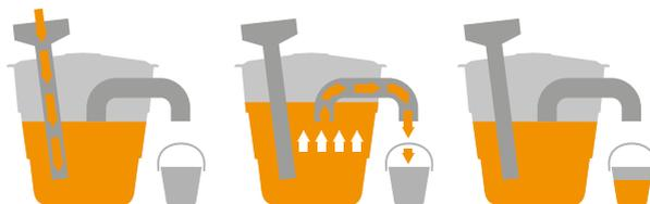
*El líquido que emerge (digestato) se debe recolectar con un recipiente para ser dispuesto como fertilizante en algún lugar deseado luego de dejarlo en contacto con el aire por al menos medio día para que se oxigene.*
