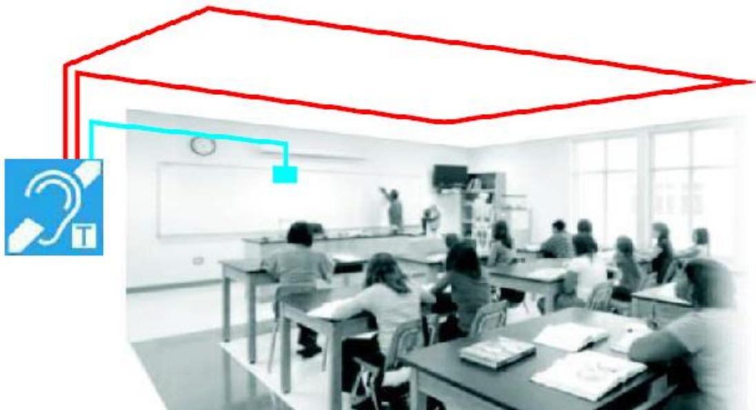
La señal (azul) es amplificada por medio de un amplificador y enviada a través del lazo (rojo) en forma de campo magnético quien luego induce a la bobina del audífono para ser escuchado por la persona hipoacúsica.
